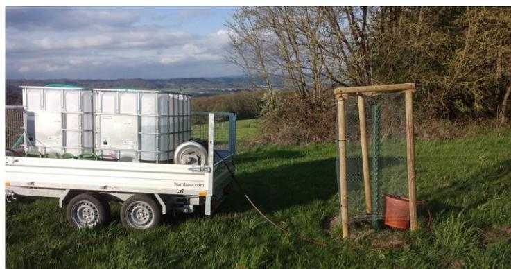
Abb. 15. Bewässerung eines Jungbaumes mit Hilfe des projektinternen Bewässerungsanhängers. Foto | Philipp Schiefenhövel
