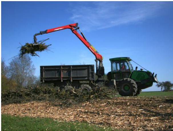
Abb. 13: Aufnahme der Schnittguthaufen der Altbaumpflege und Mulchen des Astmaterials auf zentralen Hackschnitzellagerplatz. Foto | Philipp Schiefenhövel
